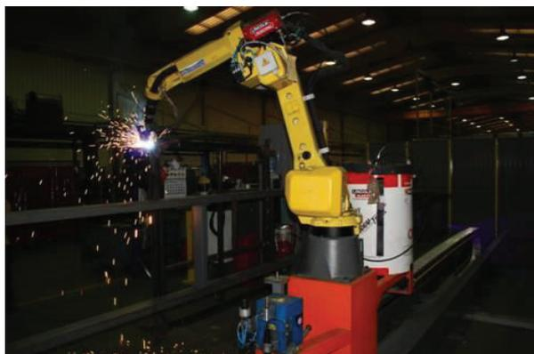
Todas las soldaduras que se necesitan para el total acabado del producto, se realizan con un sistema de soldadura continua mediante robot de alta precisión, obteniendo unos acabados de mayor resistencia.
